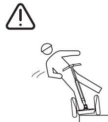
Schéma 36 : ne pas laisser une roue butter contre une bordure de trottoir
